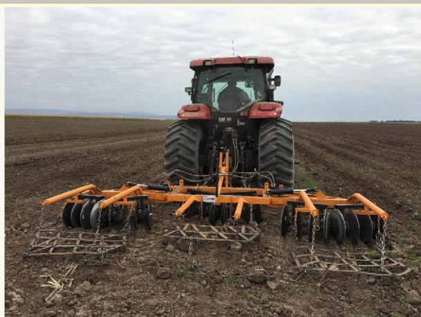
variante en la bajada de bordo se utiliza poco pero sirve, en pocas palabras, para retirar (en la primera pasada) parte de la tierra y aumentar la temperatura alrededor del brote pero sin exponer el sistema a mayores pérdidas de humedad o por controlar malezas; nivelando el terreno y conformando la forma final del surco en otro momento (la segunda pasada).
