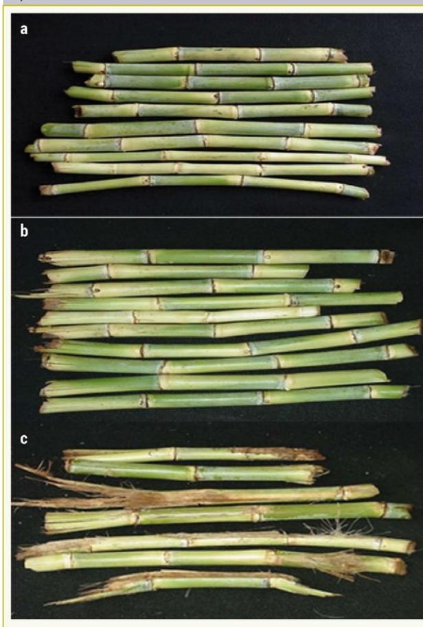
**Figura 16.** Simulación de rolos troceadores de distintos diámetros y distintas cantidad de cuchillas trozadoras
