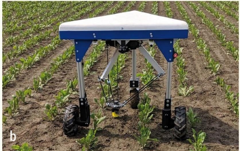
Fotos 10, 11, 12 y 13. Sistemas de control selectivo mecánico por estampado: a) Cabezal móvil equipado con una batería de tubos de estampado; b1) Maleza (en rojo) y tubo de estampado retraído antes de impactarla, b2) tubo de estampado desplegado impactando la maleza; c) Plataforma BoniRob equipada con el sistema de control selectivo mecánico por estampado.
