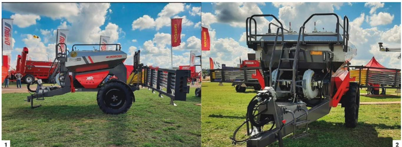
Indecar. 1) Fertilizadora Phantom 4500. 2) Detalle de las dos turbinas y de las tolvas separadas.
