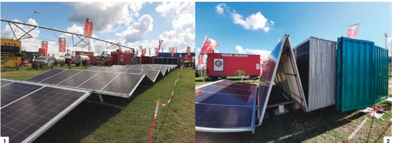
GVS. 1) Sistema de paneles solares móviles. 2) Detalle de plegado y guardado en contenedor de 20 pies.
