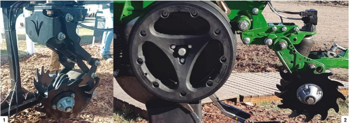
Precision Planting. 1) Sistema de variación de altura de cuchillas barre rastrojo Reveal. 2) Caños para fertilización líquida del sistema Conceal ubicados en las ruedas niveladoras y sobre el SmartFirmer.
